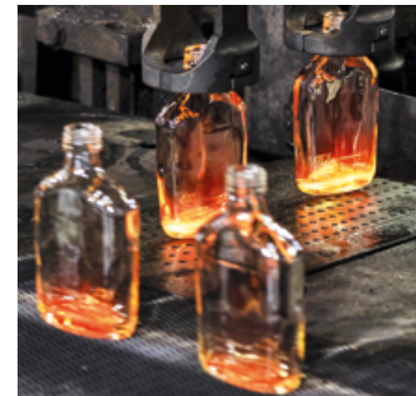
Production de flasques de Hennessy V.S dans le four électrique Verallia à Cognac.
